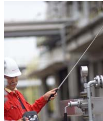
Dräger X-am 7000: Vyhledávání netěsností je usnadněno zvukovou signalizací – „tikáním“.
